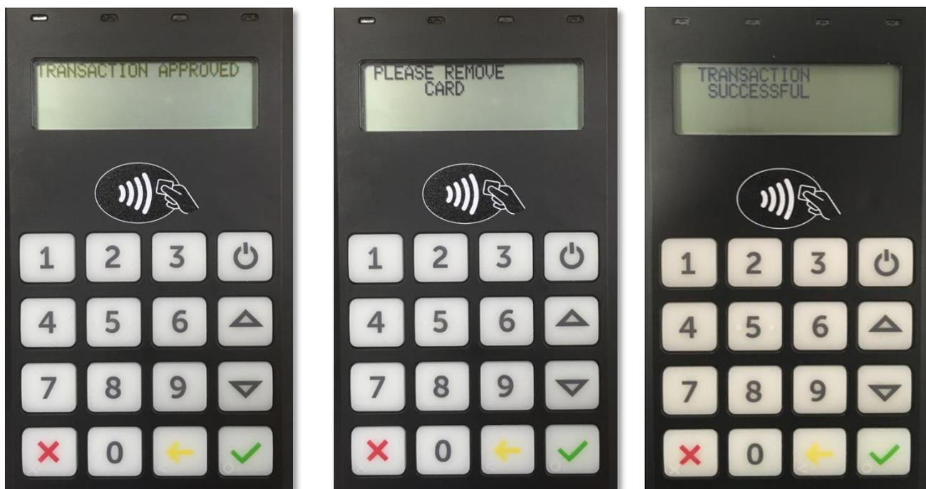
Последовательность экранов беспроводного терминала при успешном завершении операции
