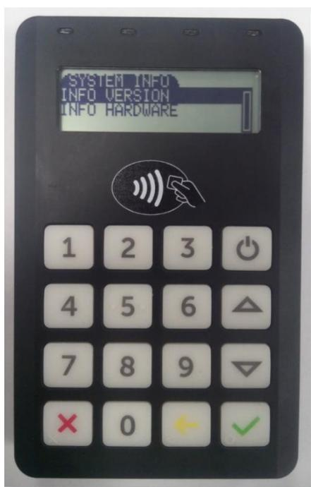
На экране отобразится информация о серийном номере устройства и номере версии его аппаратной части. Также в этом меню можно получить информацию о других технических параметрах устройства.
